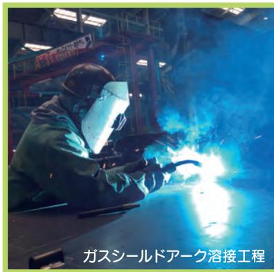
ガスシールドアーク溶接工程
