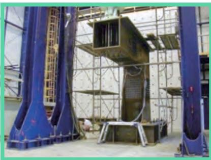
鋼製橋脚疲労実験
