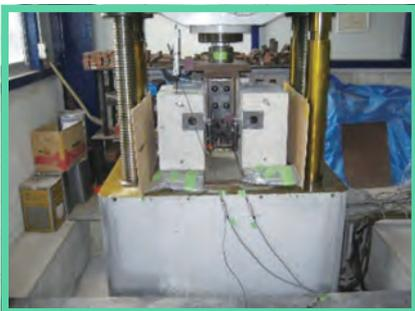
ずれ止め押し抜き実験
