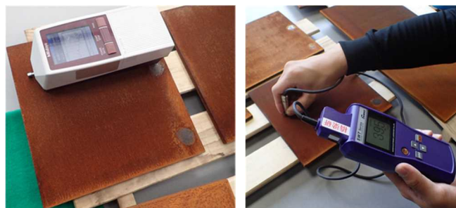
図-2 測定状況 (左: 表面粗さ, 右: 錆厚)
