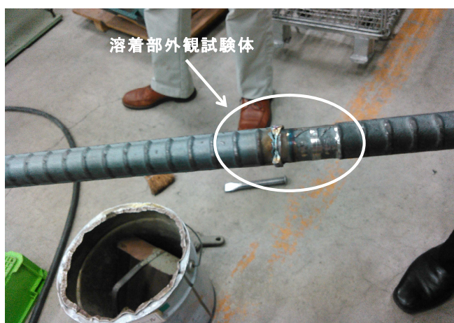
試験体（外観検査）
