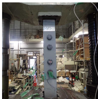
図-6 すべり試験の状況
