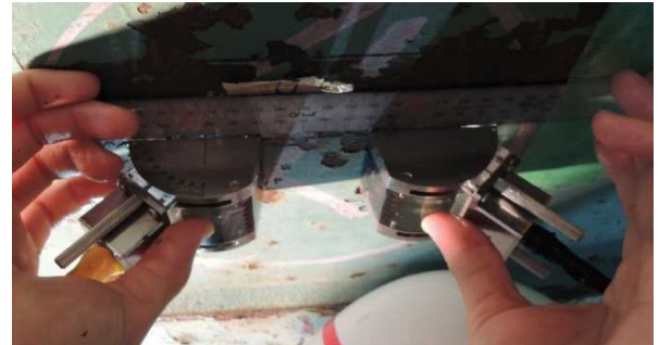
写真-2 撤去床版の位相速度計測状況
