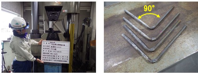
写真-3 既設鉄筋との接続部の引張・曲げ試験
