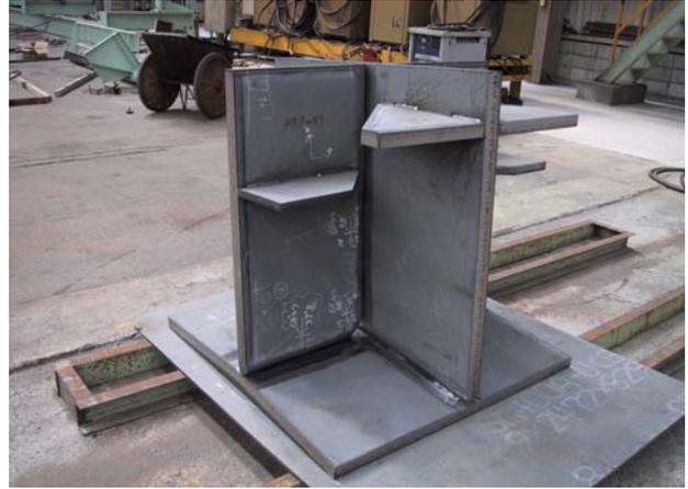
写真-1 溶接施工試験体
