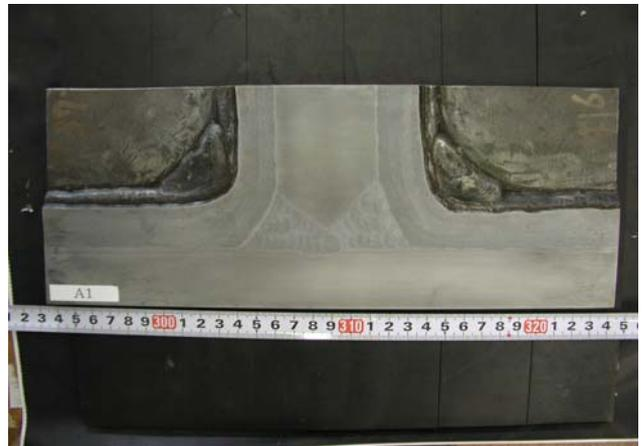
写真-2 マクロ試験片
