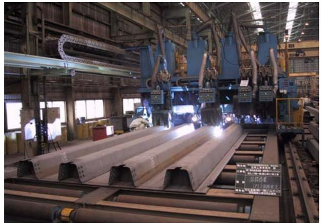
写真-2 現在のパネル溶接状況
