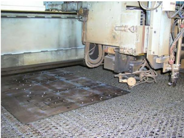
写真-9 孔明原板レーザー切断加工
