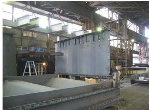
写真-8 フランジとウェブの溶接状況
