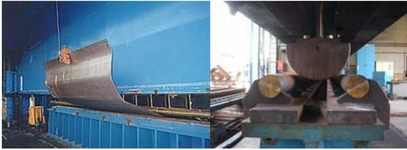
写真-4 プレーキ曲げ 写真-5 専用金型
