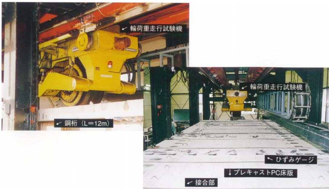
輪荷重走行試験機による疲労耐久性実験
