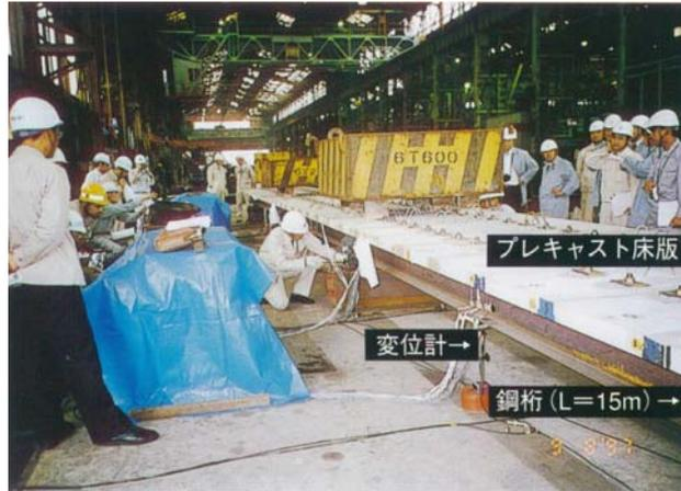
S P床版ジャッキダウン工法による連続桁の応力計測実験
