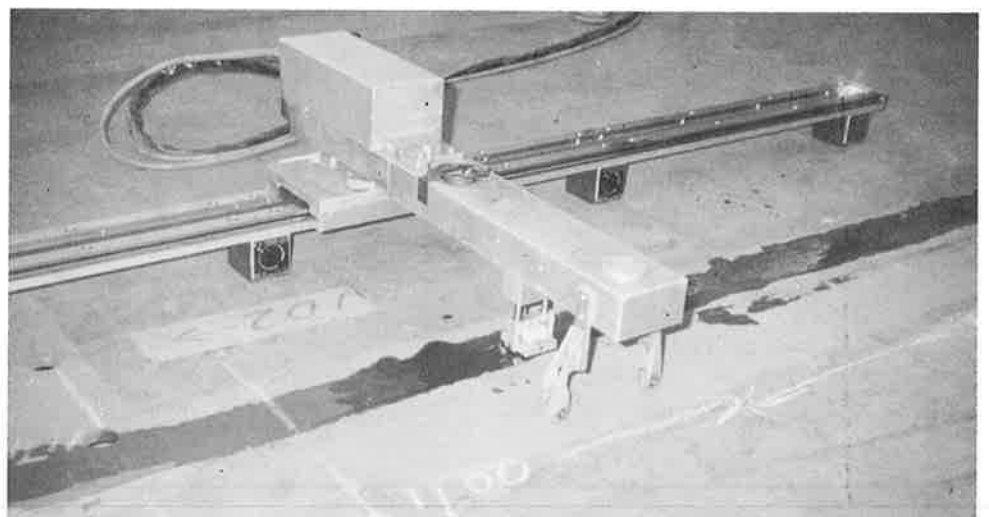
写真-1 自動探傷装置の外観
