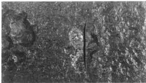
写真-1 試験片PCシリーズ 疲労破壊状況の一例
