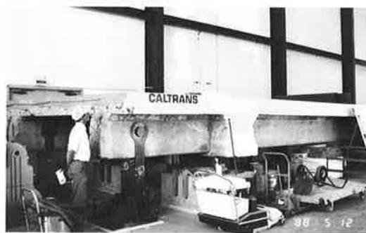
写真-8 RC床版の載荷試験供試体
