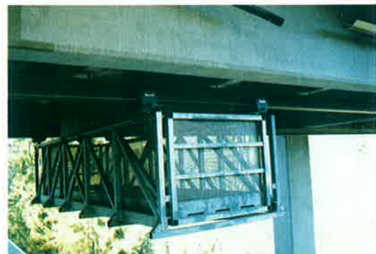
写真-55 アーチ橋の検査車
