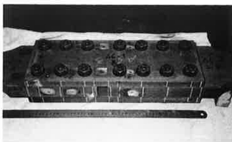
写真-2 供試体A6-3のずれ状態
