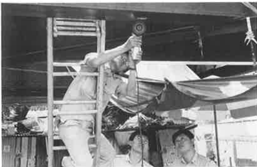
写真-24 BMCシステム診断でゲージの貼り付け実習
