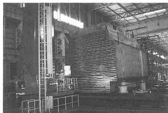
写真-1 頂板の切削
