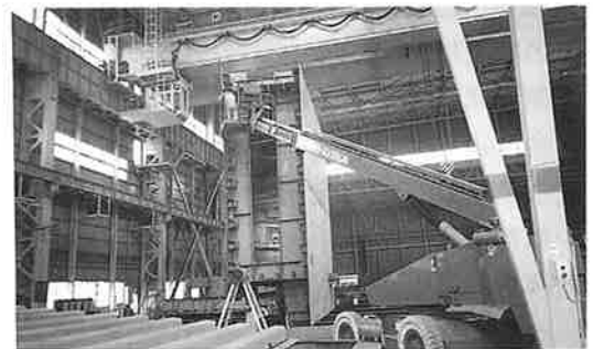
写真-4 箱桁状態で倒立させての溶接 トラフリブと横桁のすみ肉溶接をする時、良好なビード形状を得るため桁幅7mの部材を倒立させて溶接している。
