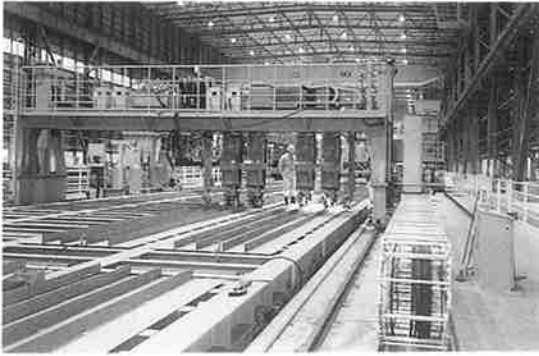
写真-4 縦リブ組立装置
