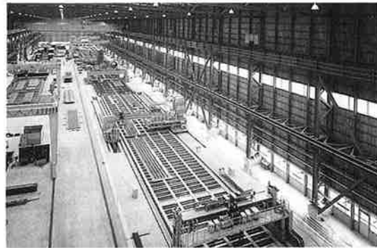
写真-3 箱桁パネル製作ライン
