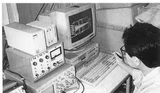
写真-4 ケーブル振動の計測状況
