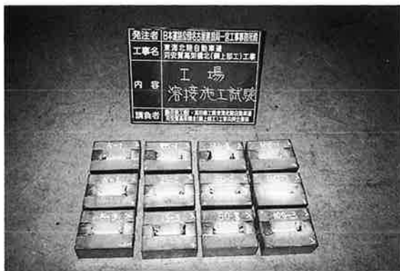
写真-2 y形割れ溶接試験
