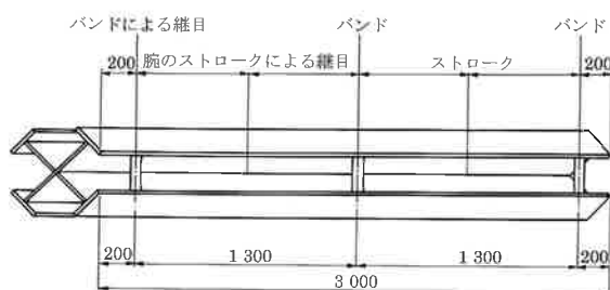
図-7 溶接継目発生位置
