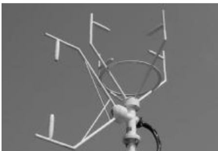
写真-1 超音波風向風速計
