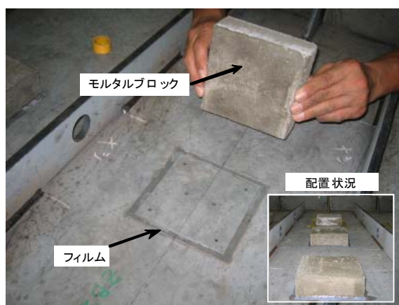
写真-2 模擬損傷の再現状況
