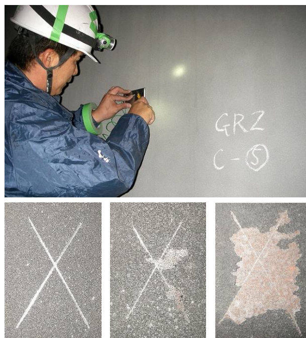
写真-16 溶射皮膜のクロスカット試験
