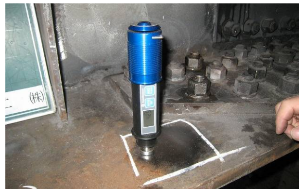
写真-14 鋼材の簡易引張強度試験
