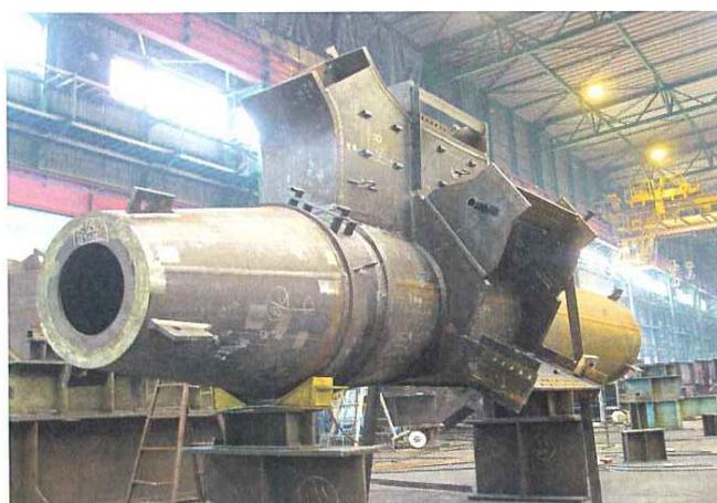
写真-4 構造切替階の鉄骨製作状況
