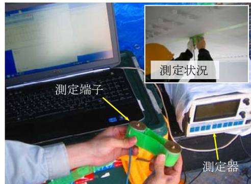
写真-3 横波振動法測定器と測定状況
