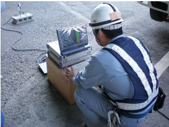
写真-4 活荷重たわみ計測状況
