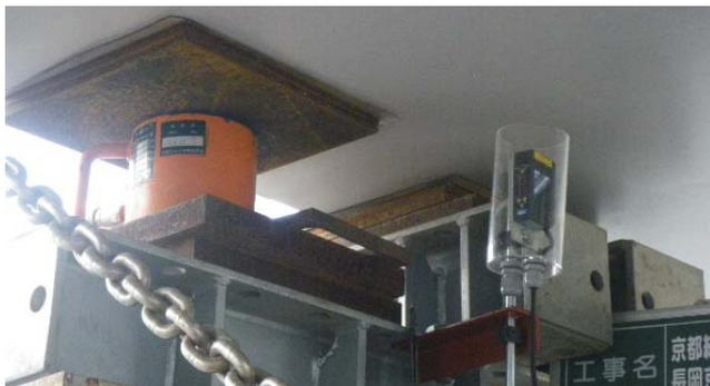
写真-9 荷重計および変位計
