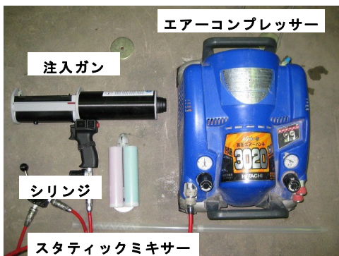
写真-1 アクリル樹脂系接着剤注入機器
