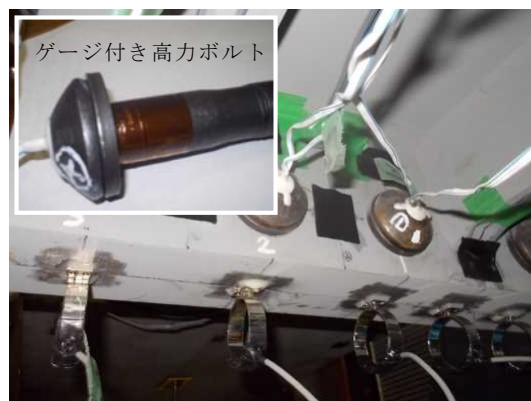
写真-3 連結部に配置したゲージ付きボルト
