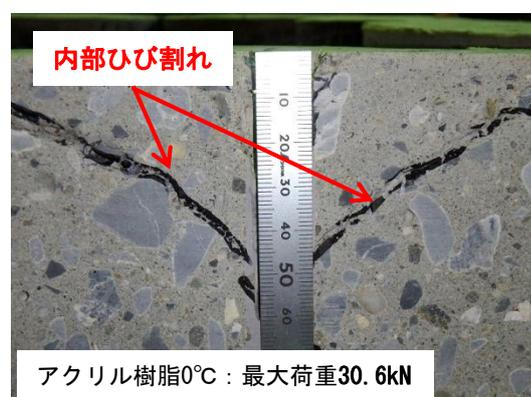
b) 内部ひび割れあり (最大荷重 30.6kN)
