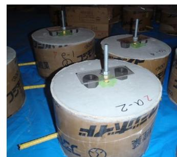
写真-2 試験体（アンカー施工中）
