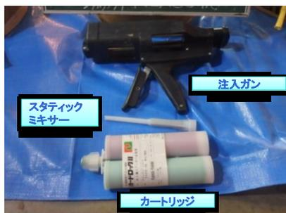
写真-1 アクリル樹脂および専用注入機器
