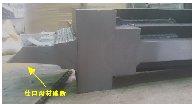
図-10 継手引張試験片破断状況例 (KT2)
