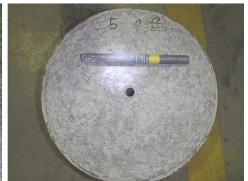
写真-7 破壊状況 (試験体 b-2)
