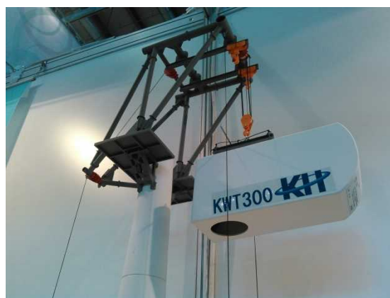
写真-4 普及説明用ナセル架設システムの模型
