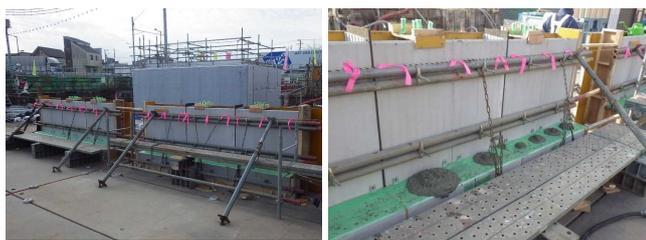
写真-4 実物大地覆高欄 打込み実験
