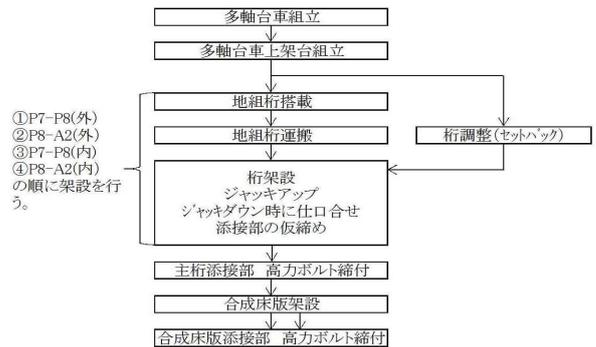
図-2 多軸台車輸送架設フロー
