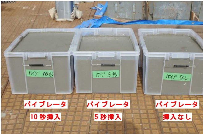
写真-4 バイブレータ挿入時間の確認
