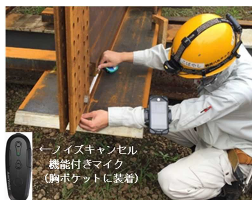
写真-4 部材計測状況（音声入力）
