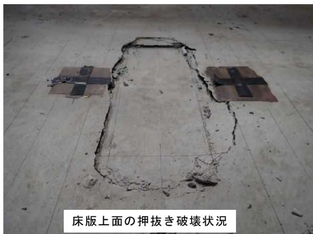
床版上面の押抜き破壊状況
