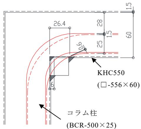
図-12 異径接合確認例(隅肉補強)
