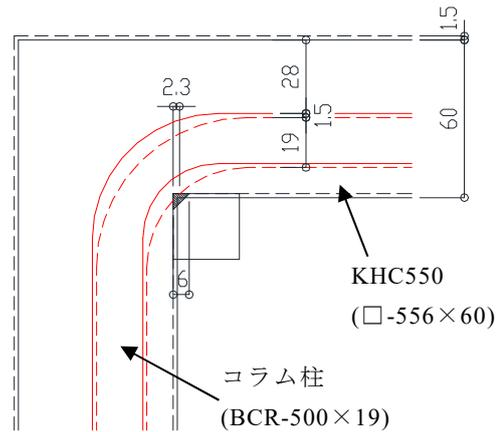
図-11 異径接合確認例(適用範囲内)
