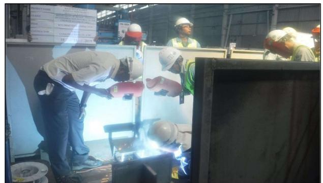
写真-1 溶接技能試験
