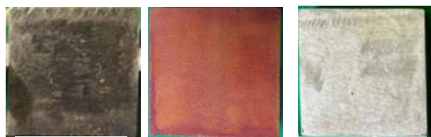
図-2 発せい前後およびさび除去後の状況
