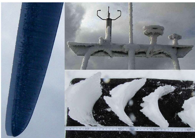
図-9 ブレード/メットマストへの着氷/着雪状況とブレードより脱落した氷 5)
