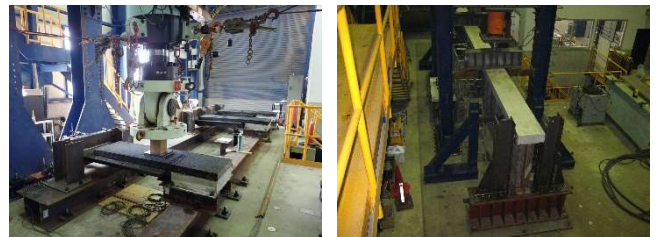
c) 舗装継手部要素試験
