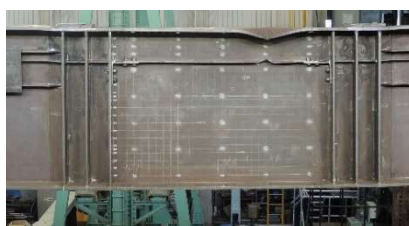
写真-2 試験後試験体状況 (着目パネル)
